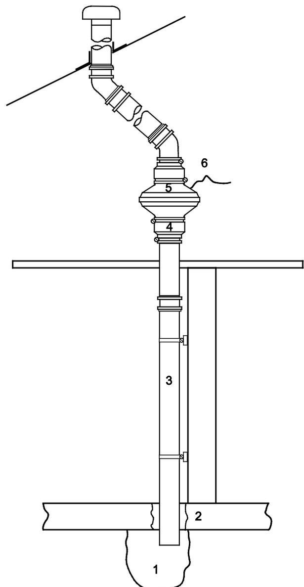
Figure 1 Internal mini sump system
