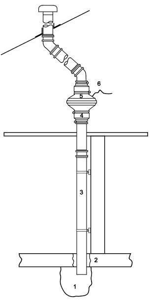
Figure 1 Internal mini sump system
